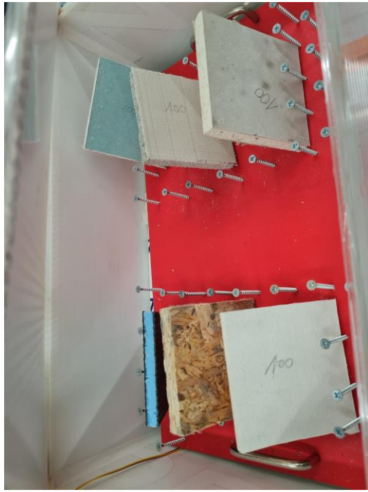
Joonis 13. Erinevate levinud ehitusplaatide hallitus- ja niiskuskindluse katsekehad TalTech Ehituse mäemaja laboris.
